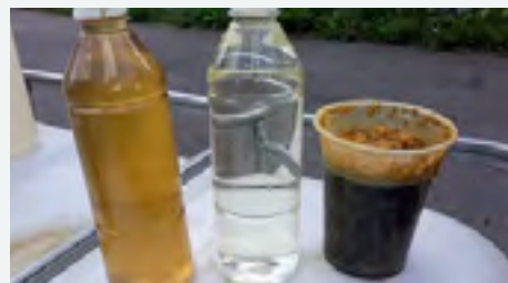
Kuva 2. Koeajojen vesinäytteitä. Vasemmalla laitteistoon ajettu vesi, keskellä käsitelty vesi ja oikealla erottunut flokki
